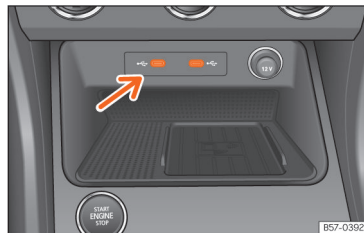
Fig. 160 Centre console: USB input.
